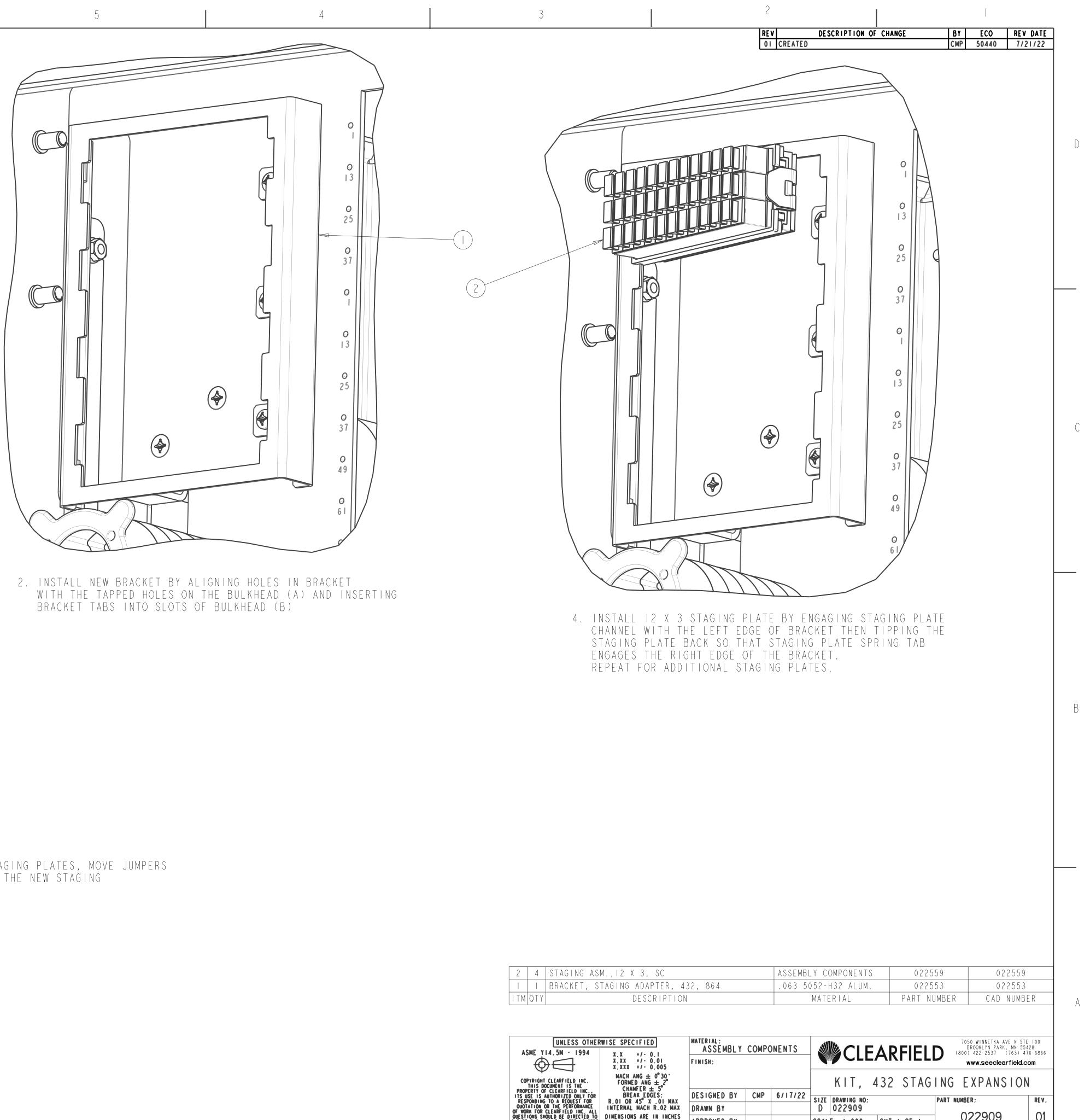
5. AFTER INSTALLING STAGING PLATES, MOVE JUMPERS FROM OLD STAGING TO THE NEW STAGING
